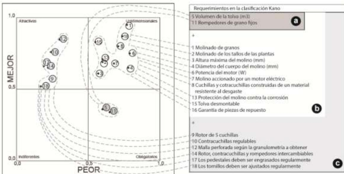
**Fig. 2.** Clasificación Kano de los requerimientos en base a un producto básico (a), esperado (a+b) y ampliado (a+b+c)
