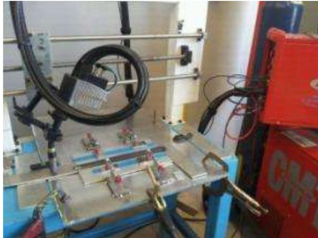
**Fig. 1.** Instalación para posicionar y sostener los cupones, así como para el desplazamiento regulado de la antorcha CMT, diseñada y fabricada por el autor (CIDTS)
