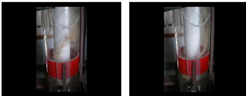
Fig. 2. Fotografías de una de las capas de material formadas durante el funcionamiento de la llamada Columna para Movimiento en Espiral Ascendente
