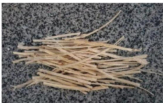
**Fig.1.** Fibras de caña de azúcar listas para el uso en el material compuesto
