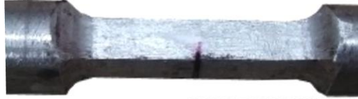
a) ) Medición de la grieta (3,01 mm) en la probeta 4
