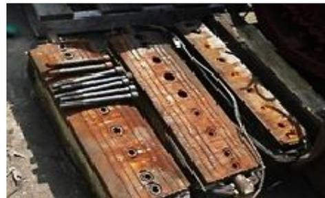
**Fig.1.** Vista del rotor y el estator inutilizados **Fig.2.** Zapatas polares desprendidas y pernos dañados
