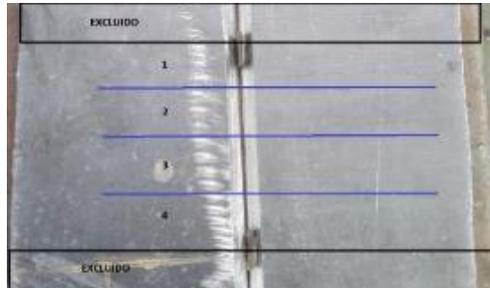
Fig. 2. Distribución de las probetas en la junta soldada. Fuente: autores
