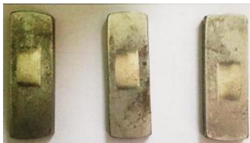
Fig. 3. Huella del desgaste en las probetas. Fuente: autores
