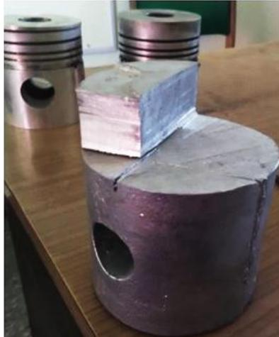
**Fig.10.** Pistones sin defectos y pistón seccionado mostrando la ausencia del rechupe y poros. Fuente: autores
