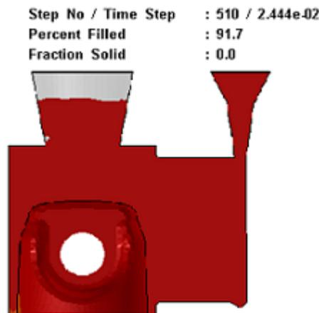
**Fig. 9.** Simulación del molde propuesto donde no existe turbulencia generada durante el llenado. Fuente: autores
