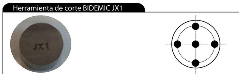
**Fig. 2.** Puntos de medición de dureza en la herramienta. Fuente: autores
