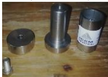
Fig. 2. Molde utilizado para la construcción de los andamios. Fuente: elaboración propia
