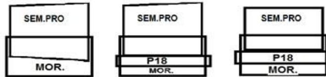
Fig 5. Secuencia de desbaste en la limadora. Fuente: autores
