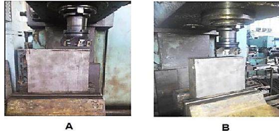
Fig. 6. Instalación en la fresadora. Fuente: autores
