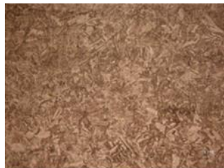
Fig. 2. Muestra metalográfica a 500X de la estructura templada y revenida. Fuente: autores
