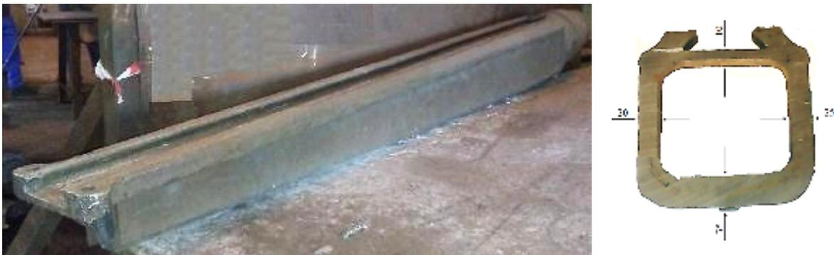
**Fig 1.** Brazo de barrido y sección transversal. Fuente: autores
