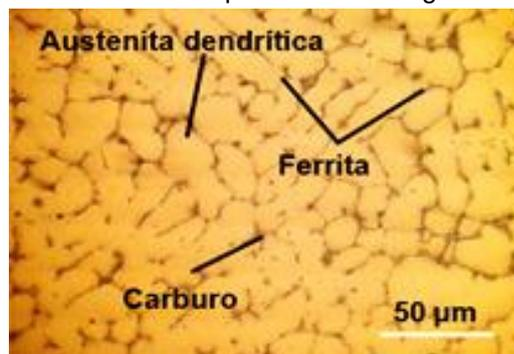
**Fig. 4.** Microestructura del HK-40 (400 x). Fuente: autores
