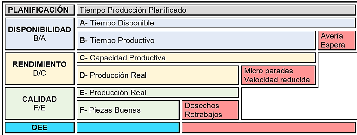
Fig. 1. Grafico que muestra cómo obtener los tres factores del OEE. Fuente: [12]
