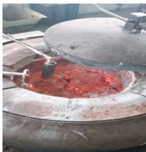
Fig. 5. Horno empleado para la aleación. Fuente: autores
