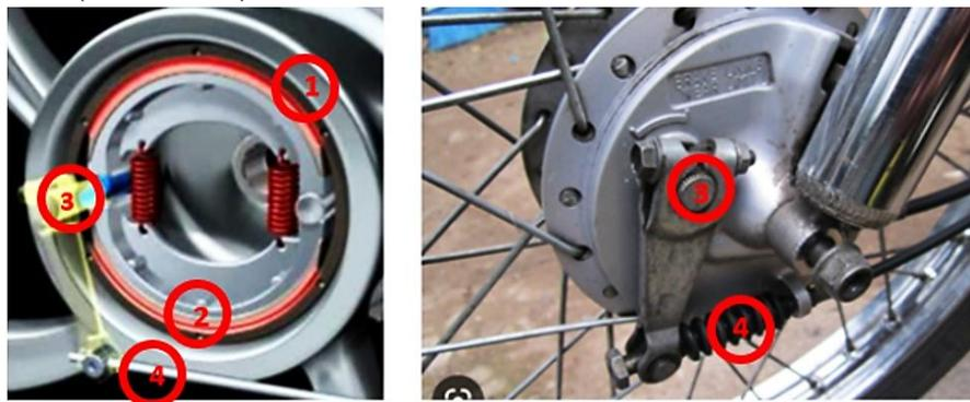
**Fig. 2.** Mecanismo de freno de zapatas accionado por cable. (1) Tambor, (2) Zapatas, (3) Leva, (4) Cable. Fuente: autores
