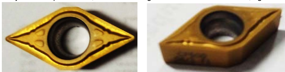
Fig. 2. Placa recubierta de nitruro de titanio código VCMT110304-03TIN16. Fuente autores
