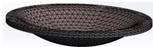
Fig. 4a. Modelo mallado. Fuente: autores
