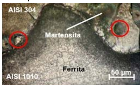
Fig.6a. ZAC a 15 mm de la explosión. Fuente: autores
