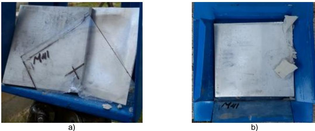
**Fig. 2.** Ejemplo de ensayo de impacto real del proyectil 7,62 mm en la muestra M41. a) Resultado del impacto, b) Restos de cerámica CC-01 sobre la placa de aluminio AA 6061. Fuente: autores
