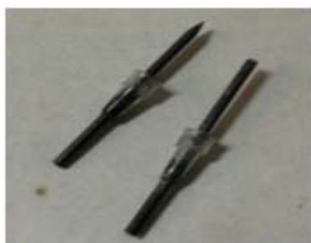
Fig. 3 Puntas de carbón (electrodos)
