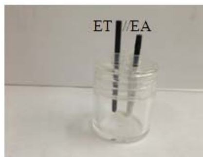
Fig. 7 Celda completa con el ET de barra de carbón y el EA separado con papel absorbente
