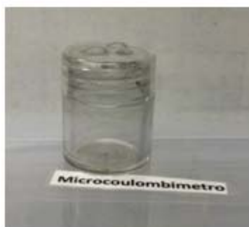
Fig. 1 Frasco que funcionará como celda
