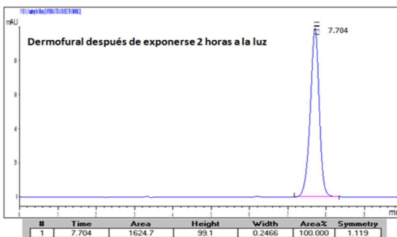
Figura 8. Cromatograma de una disolución de muestra de ensayo (Dermofural), después de 2 h expuesta a la luz del laboratorio
