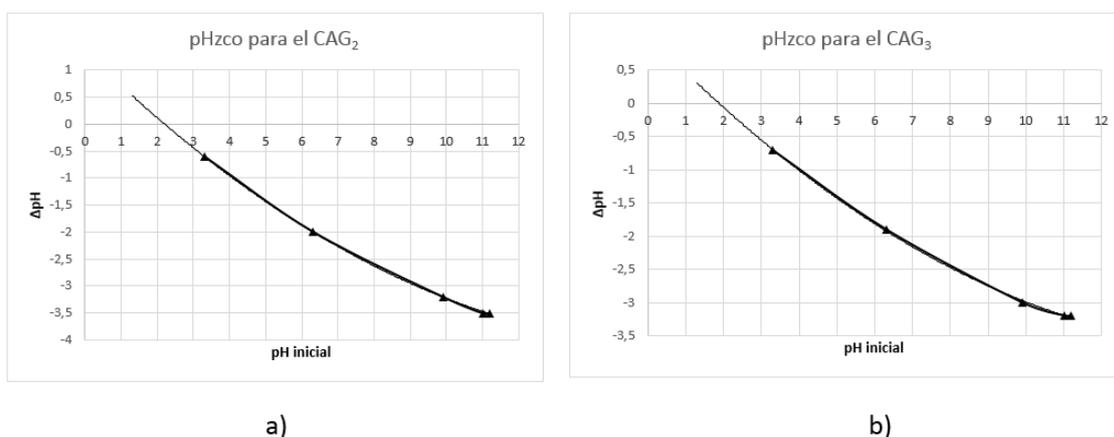
Figura 5. pH en el punto de carga cero (pHzco) a) CAG<sub>2</sub>, b) CAG<sub>3</sub>
