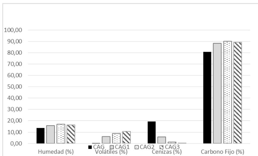
**Figura 1. Contenido de humedad, volátiles, cenizas y carbono fijo**
