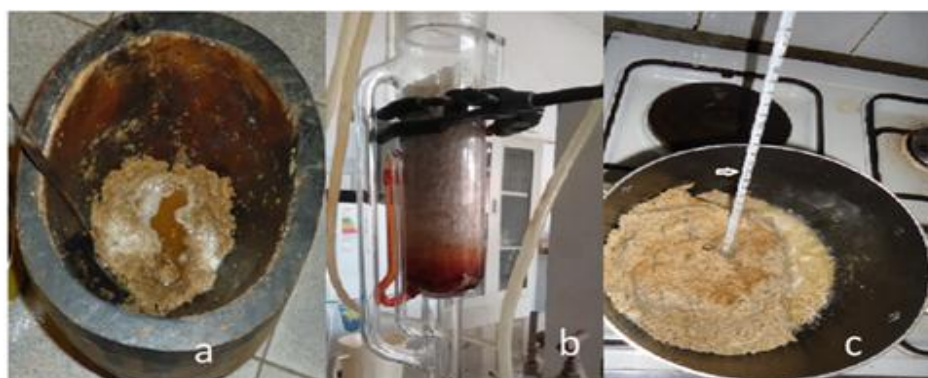
Fig. 2- Processos de extração de óleos: a) prensa a frio e b) soxhlet; c) cozimento do material vegetal
