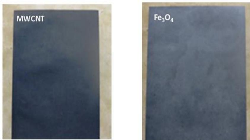
**Fig. 2.** Micrografía óptica de las muestras obtenidas en la formulación de papel con nanopartículas
