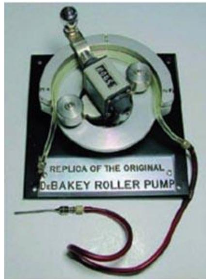
**Fig. 1-** Réplica de la bomba de rodillos diseñada por DeBakey. Tomado de *Schmidt PJ*.<sup>(14)</sup>
