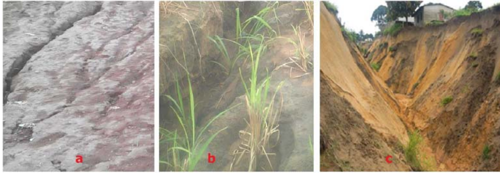
Figura 4. Tipos de erosión hídrica en la ciudad de Brazzaville (a. Erosión laminar, b. Erosión en surcos y c. Erosión por cárcavas).
