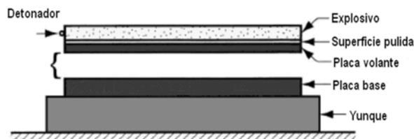
Figura 1. Preparación de la unión para la soldadura.
