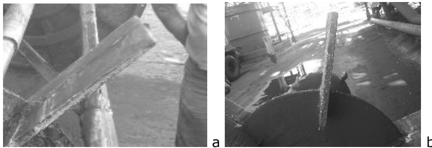
Figura 5. Impelentes después de 240 días de trabajo.
