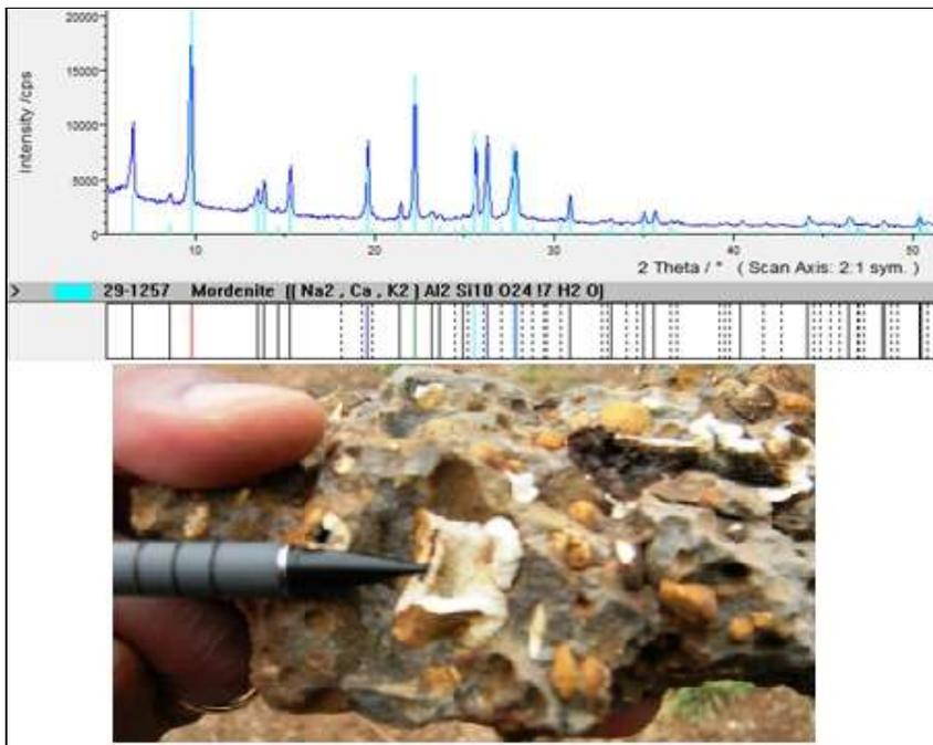
Figura 8. Difractograma de la muestra P-1, cerca de Boane. Las amígdalas del basalto (foto de abajo) están rellenas por mordenita de hábito fibroso y color blanco.
