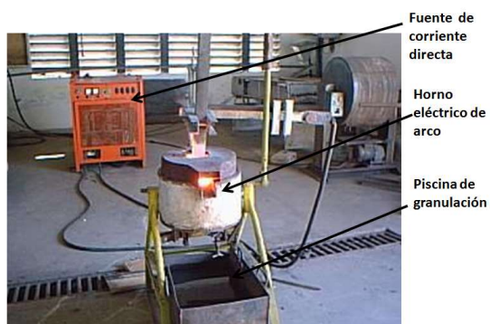
Figura 1. Equipamiento utilizado para la obtención carbotérmica de las ferroaleaciones al Cr-Mn.
