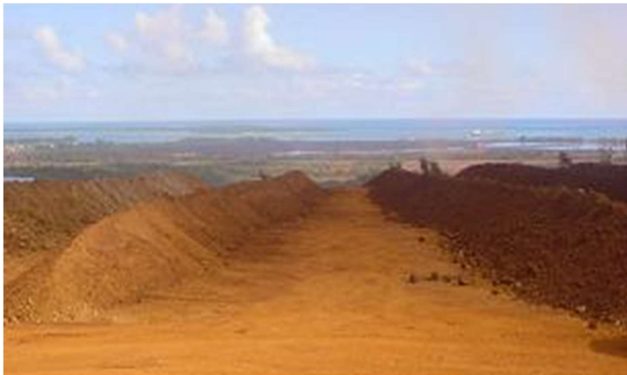
Figura 4. Pilas de mena laterítica expuestas a secado natural. Fuente: Retirado (2012).
