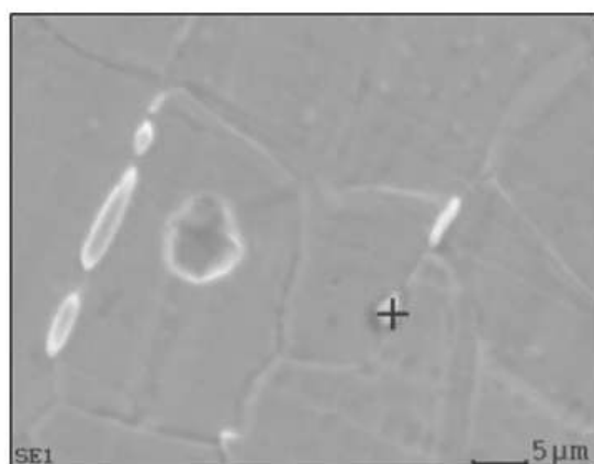
Figura 11. Imagen (izquierda) y espectro (derecha) del microanálisis del precipitado del material base en la zona de la fractura.
