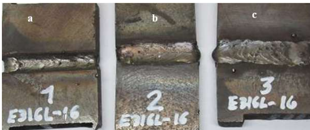
Figura 2. Unión soldada con el electrodo E 316L-16. (a): depósito de un cordón de soldadura; (b): depósito de dos cordones de soldadura; (c): depósito de tres cordones de soldadura.
