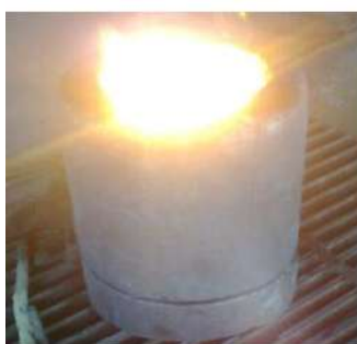
Figura 1. Reactor de grafito durante el procesamiento aluminotérmico.
