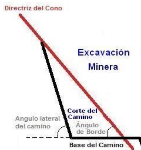
Fig. 4 - Perfil de un camino en ladera.
