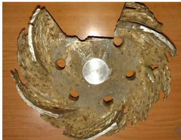
Figura 1. Impelente afectado del cual se tomó una sección para el análisis microestructural.
