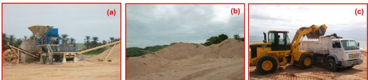
Figura 7. Planta de procesamiento de arena. (a) Proceso de clasificación granulométrica; (b) Área de acopio; (c) Carga de camión.
