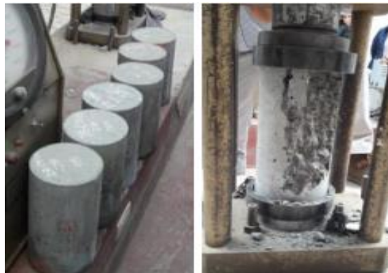
Figura 5. Elaboración y rotura de las probetas de hormigón.
