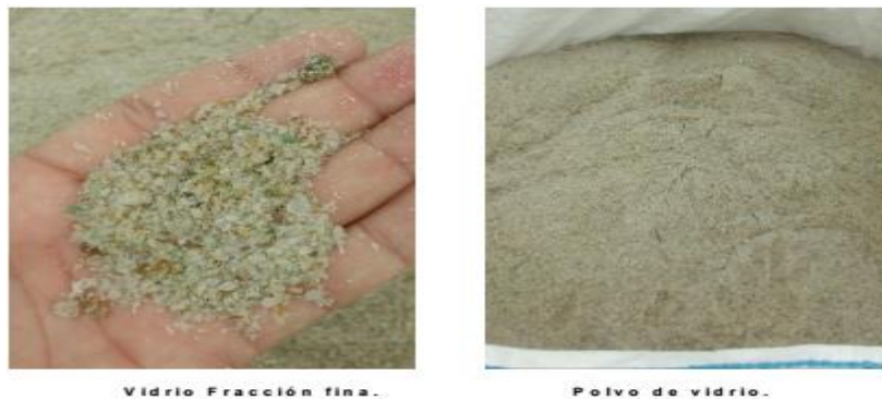
Figura 4. Fracción fina de vidrio y polvo de vidrio.
