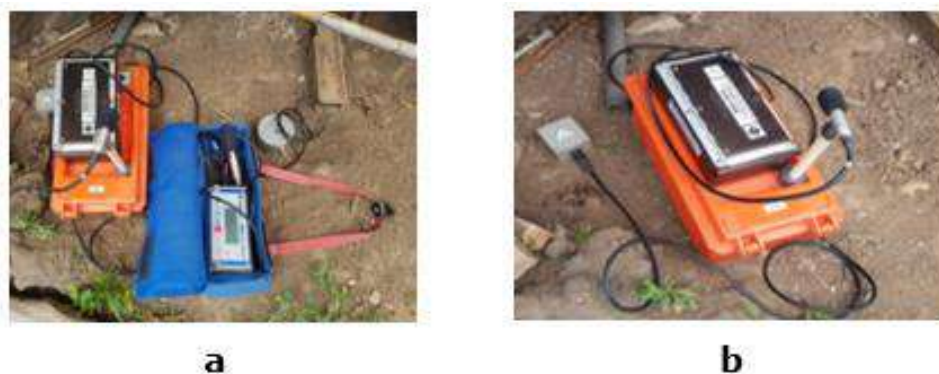
Figura 6. Equipos empleados. a. Sismógrafos de registro. b. Sismógrafo marca White.
