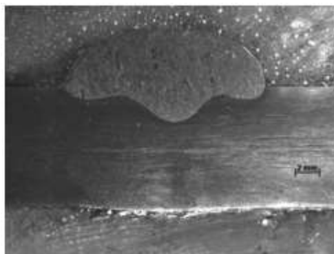
Figura 1. Macrografía de la ZAC de la soldadura realizada con 1,5 kJ/mm.
