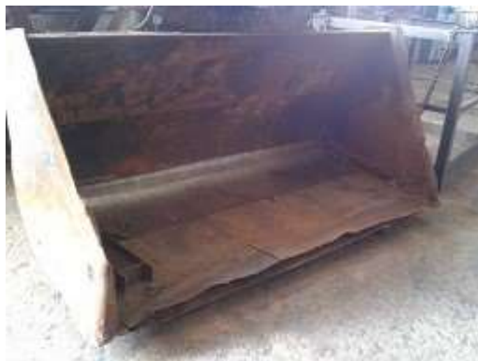
Figura 1. Deformaciones en las paredes laterales y desunión de las planchas por pérdida de las cuchillas en uno de los cubos.
