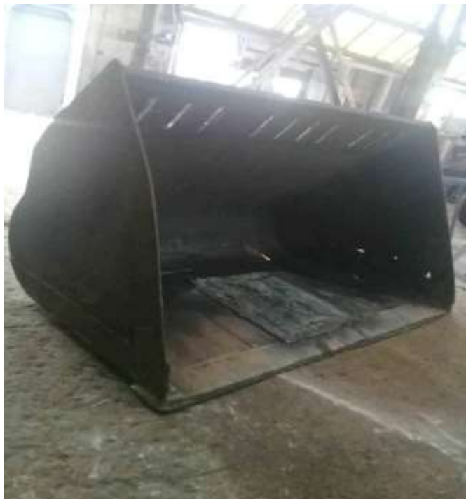
Figura 2. Imagen de un cubo del cargador frontal reparado por el procedimiento propuesto.
