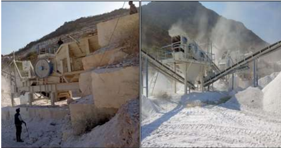
Figura 2. Trituradores de mandíbula y sistema de clasificación empleados para la obtención de las fracciones granulométricas estudiadas. Fuente: cortesía Empresa Megastone.
