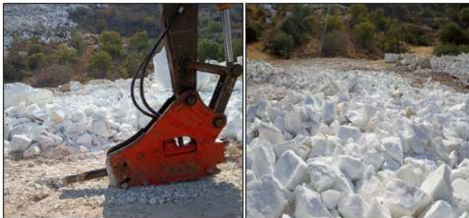
Figura 1. Preparación mecánica de las muestras de PAM. Fuente: Autoría propia.
