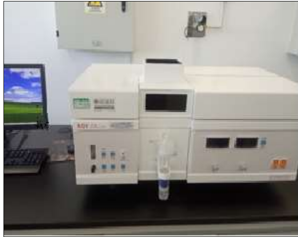
Figura 3. Espectrofotómetro de absorción atómica utilizado para los análisis químicos. Fuente: Cortesía Laboratorio de Geología (IGEO 2021).
