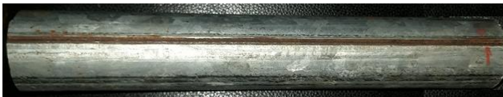
Figura 2. Tramo de tubo seleccionado luego de conformado y soldado.
