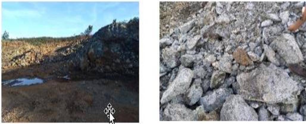
Figura 2. Cantera de serpentinitas usada como material de préstamo para el mantenimiento de algunas calles en la ciudad de Moa (izq.). Serpentinitas extraídas de la cantera (der.).
