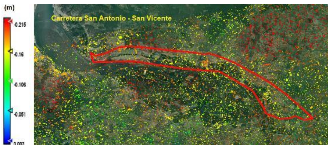
Figura 14. Resultados de los desplazamientos para el periodo 2017-2019.
