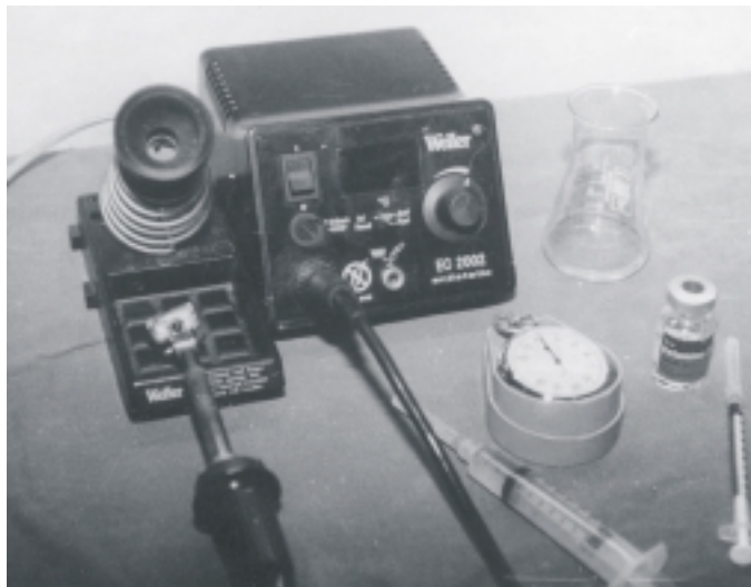
FIG. 1. Equipo de soldadura automática digital acoplado a dispositivo con 2 placas para transmitir calor.
