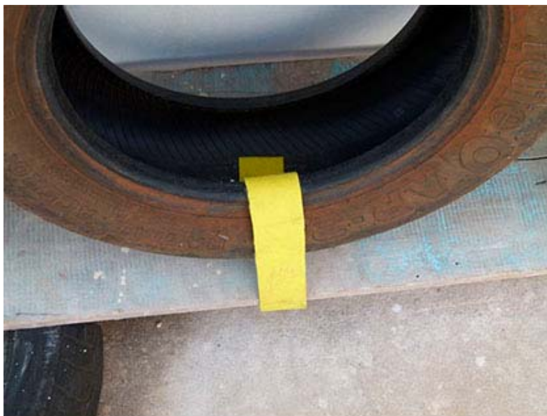
Fig. 2. Posición de la membrana de drenaje en el interior de uno de los neumáticos del experimento.
