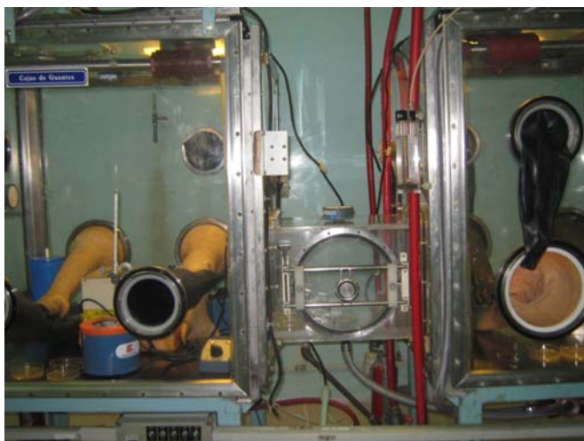
Figura 14. Modificaciones cajas de guantes. Producción de Fosfato Crómico ^{32}\text{P} .
