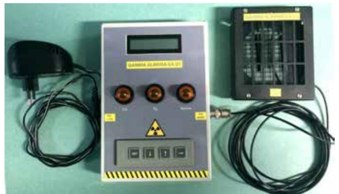
Figura 6. Instrumento Alarma Gamma para la protección radiológica instalado en el CEADEN.
